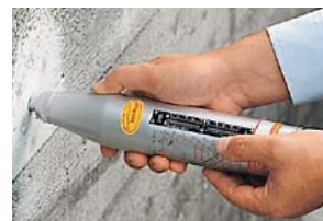
Fig. 11: Exemple de martell d'Schmidt. El martell disposa d'un percutor que reacciona de forma inelàstica a l'impacte contra una superfície sòlida. El valor del rebot és proporcional a la duresa de la superfície i aquesta a l'alteració de la mateixa.
