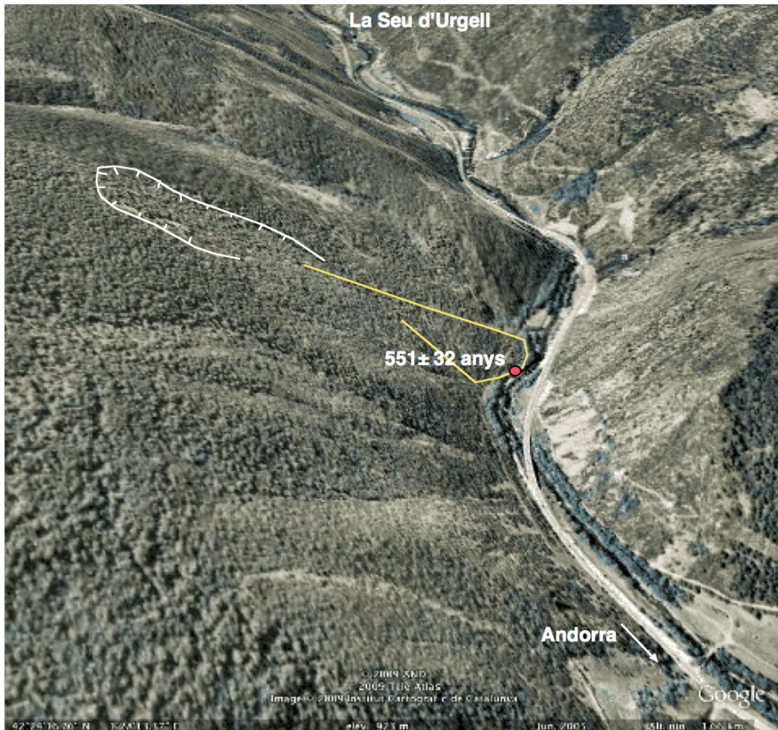
Figura on s'exposa un esquema de l'esmentat moviment del vessant que afecta l'antiga carretera C1313 en el seu pas pel Pont Trencat. Aquest esllavissament va obtenir el riu Valira acumulant llims lacustres que han estat possible datar-los mitjançant la tècnica d'OSL, finançat per la Fundació Marcel Chevalier i cedida exclusivament per a l'ús en aquest informe.
