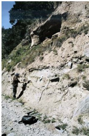
Fig. 6: Mostreig del nivells de sorres per datació OSL (Optical Stimulate Luminiscence)
