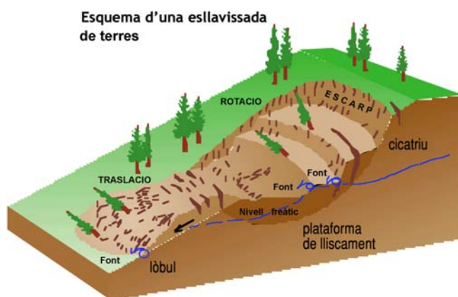
Figura 4: Esquema d'un esllavissament. original de la revista Horitzó 8 (2005) i modificat.
